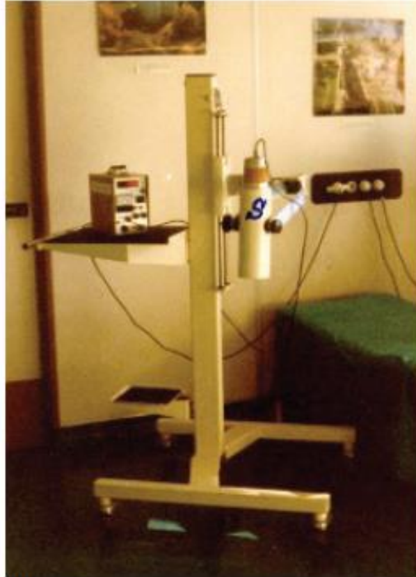
Slika 3. Gama scintilaciona sonda sa elektronskim mernim uređajem, koja služi za merenje radioaktivnosti bolesnika (jetre, slezine i srca) u cilju određivanja mesta sekvestracije eritrocita obeleženih hromom-51.
