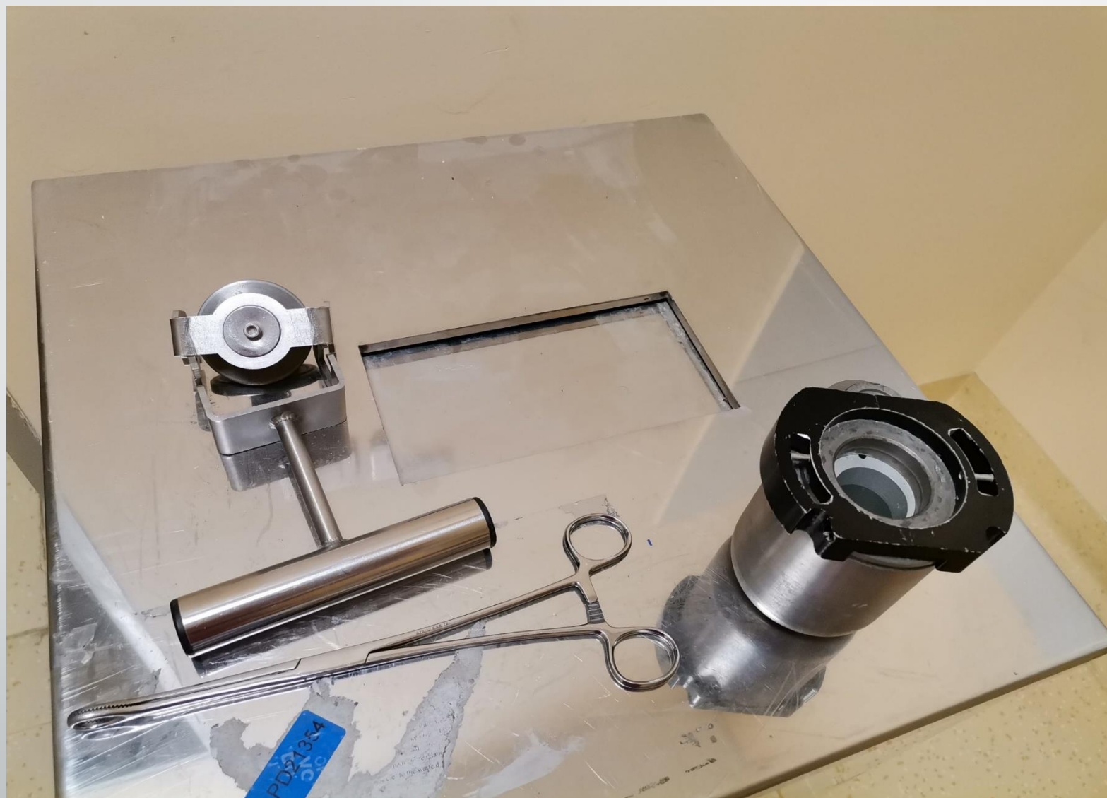
PRENOSIVI, ZAŠTITNI KONTEJNER ZA FDG-F18 KOD AUTOMATSKOG INJEKTORA
